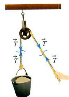
La tensión de la cuerda actúa en el balde, en la polea y en la mano de la persona.
