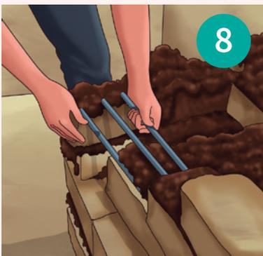
Colocar las varillas de 5/8 de pulgada de diámetro por 40 cm de largo.
